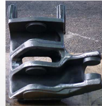
Swing frame for a mini excavator, EN-GJS-500, 16 kg
